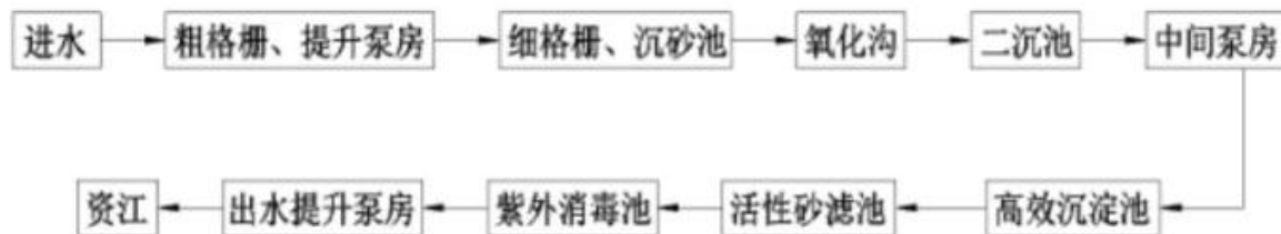
图 7-3 城北污水处理厂处理工艺流程图
