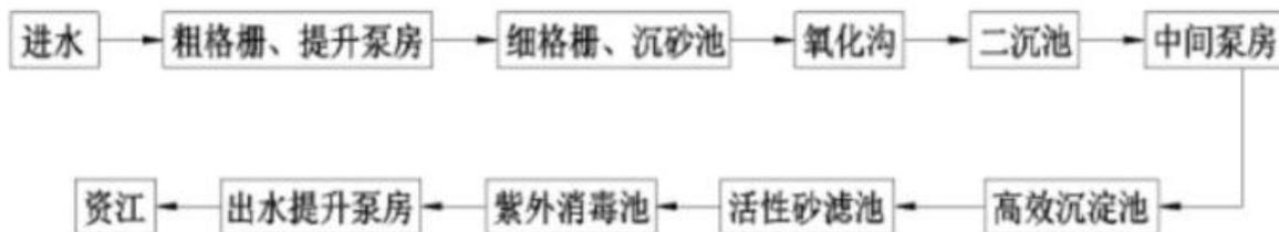
图 7-3 城北污水处理厂处理工艺流程图
